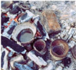
塩作りの実験（炭火で海水を熱しています）
